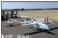
(出所：福島県) 福島ロボットテストフィールド 「固定翼ドローン試験飛行」
